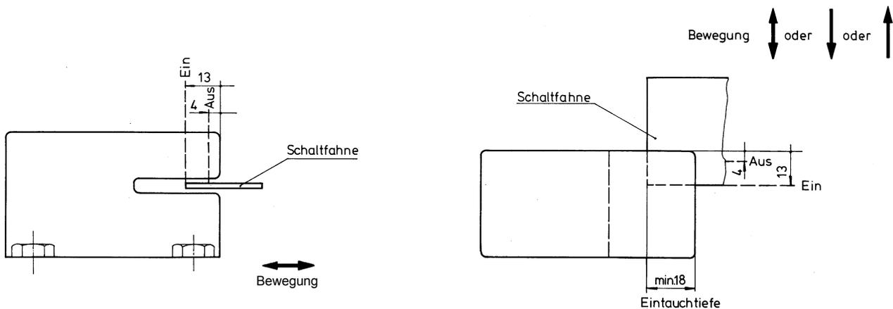
Die angegebenen Werte sind Richtwerte, die je nach Schaltertoleranz, Schaltfahnenengröße, Schaltfahnenmaterial und Einbauverhältnissen abweichen können. Sie bleiben aber nach dem Einbau des Schalters konstant.
