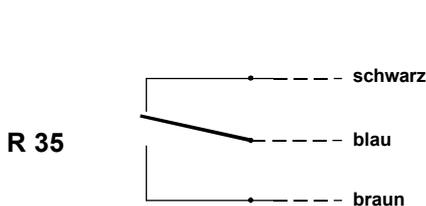
Die Darstellung zeigt den Schaltzustand, wenn dem aktiven Bereich des Schalters ein magnetischer Südpol angenähert ist oder zuletzt angenähert war.
