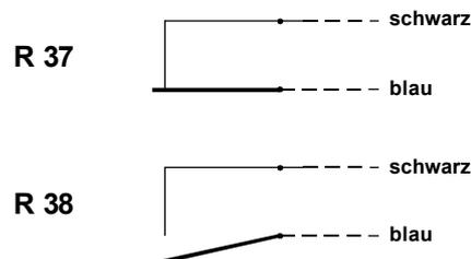
Die Darstellung zeigt den Schaltzustand, wenn dem aktiven Bereich des Schalters ein magnetischer Südpol angenähert ist oder zuletzt angenähert war.
