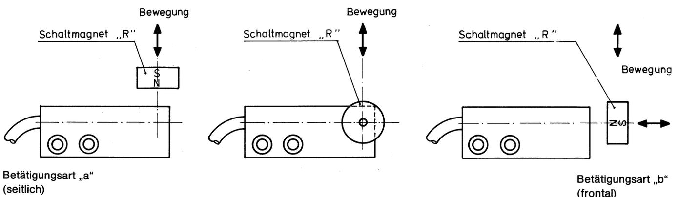
Die Betätigung dieses Schalters erfolgt durch einen getrennt angebrachten Magneten, der dem Schalter angenähert und entfernt wird.
