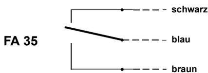
Die Darstellung zeigt den Schaltzustand, wenn dem aktiven Bereich des Schalters ein magnetischer Nordpol angenähert ist oder zuletzt angenähert war.
