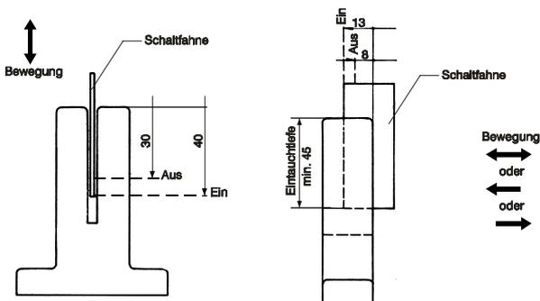
Die angegebenen Werte sind Richtwerte, die je nach Schaltertoleranz, Schaltfahnen­größe, Schaltfahnen­material und Einbauverhältnissen abweichen können. Sie bleiben aber nach dem Einbau des Schalters konstant.
