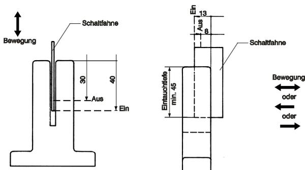
Die angegebenen Werte sind Richtwerte, die je nach Schaltertoleranz, Schaltfahnenlänge, Schaltfahnenmaterial und Einbauverhältnissen abweichen können. Sie bleiben aber nach dem Einbau des Schalters konstant.
