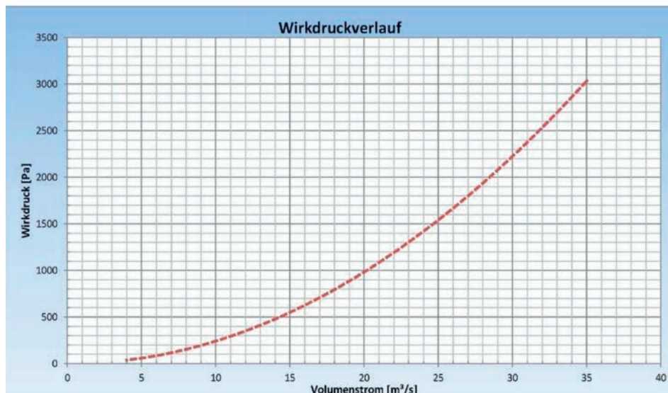
Beispiel einer Kennlinie eines gebräuchlichen Lüfters.
