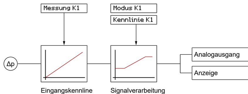
Abb. 62: Parametrierung der Kennlinie K1
