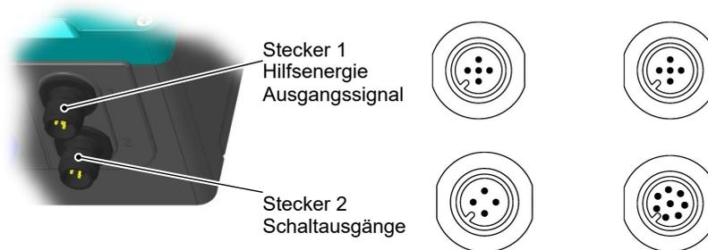
Abb. 3: Elektrische Anschlüsse
