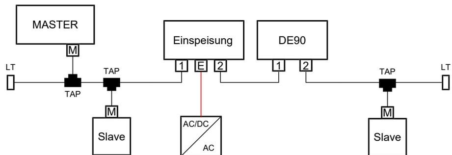
Abb. 25: Modbus Anschluss
