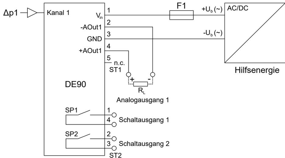
Abb. 17: 1 Kanal Ausführung (mit Analogausgang)
