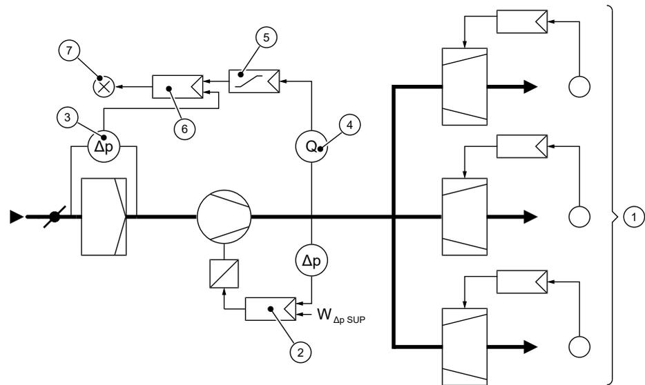
Abb. 110: Prinzip-Schema Filterüberwachung
